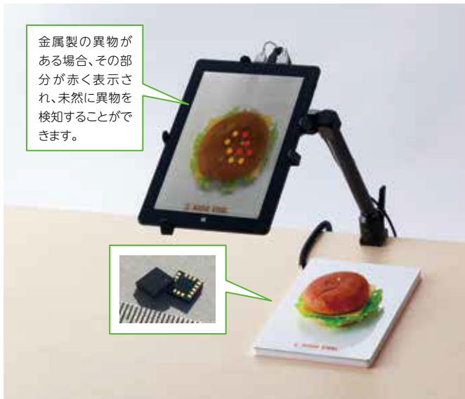
タブレットを利用したモバイル型異物検知装置と“MIセンサ”
