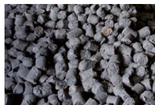
分別樹脂類(ASR)を活用した製鋼用電気炉の原燃料
